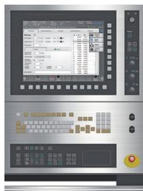
Es werden die Achsen X, Y, C, U, Z und W CNC-gesteuert, dies als Standard mit der Fanuc 30i. Auf Basis dieser Steuerung haben wir KELLENBERGER H2000-Softwarezyklen geschaffen, damit die Steuerung den besonderen Anforderungen des Koordinatenschleifens vollauf gerecht wird.
